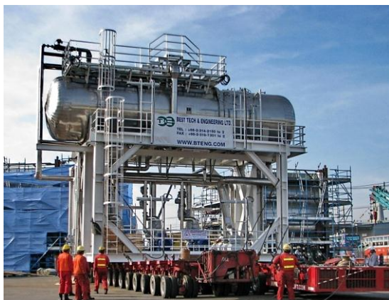
อุปกรณ์แยกอากาศออกจากไอน้ำ โครงการ Golar Winter Renovation of FSRU ประเทศบราซิล
