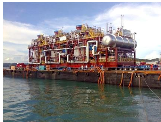
เครื่องกำเนิดไอน้ำ (Boiler Module) โครงการ Peregrino FPSO Project ประเทศบราซิล
