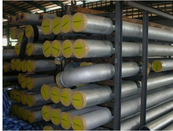
ระบบท่อแรงดันต่ำ (Low Pressure Piping) โครงการ Afam VI ประเทศไนจีเรีย
