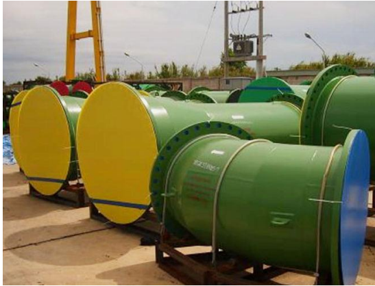
ระบบท่อน้ำระบายความร้อน (Main Cooling Water System) โรงไฟฟ้าพระนครเหนือ จังหวัดนนทบุรี ประเทศไทย
