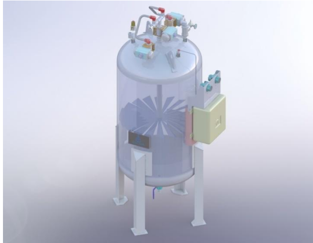
ถังที่ช่วยรักษาระดับความดันของก๊าซธรรมชาติให้คงที่ (Injection - NGV Trailer Decanting System (ITDS))
