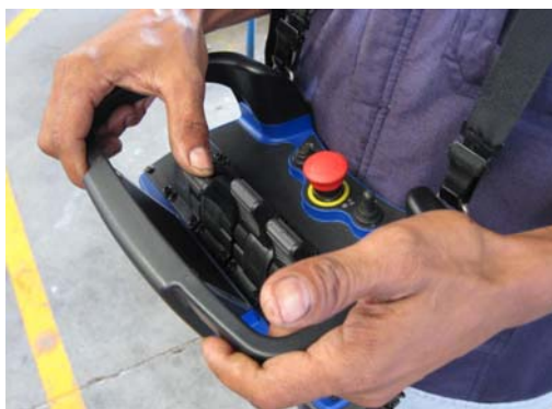
รีโมทคอนโทรลสำหรับบังคับเครื่องระบบไฮดรอลิก
