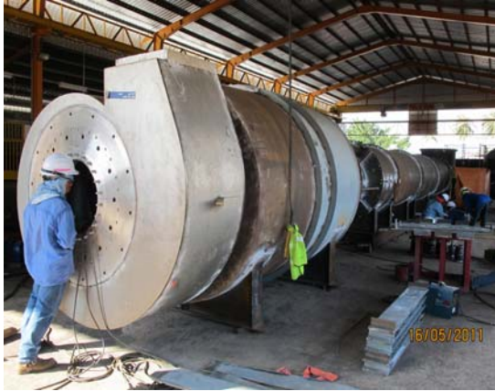
อุปกรณ์ที่ประกอบที่โรงงานเพื่อรอการนำไปติดตั้ง
