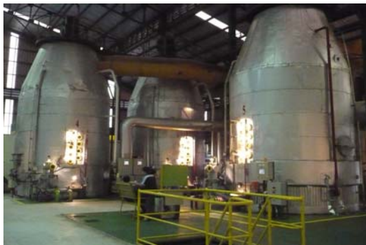
การเคี่ยวน้ำตาลให้ตกผลึกและการปั่นแยกน้ำตาล
