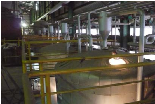
การฟอกเพื่อลดค่าสีน้ำตาลด้วยเรซินแลกเปลี่ยนอิออน (Ion-Exchange Resin)
